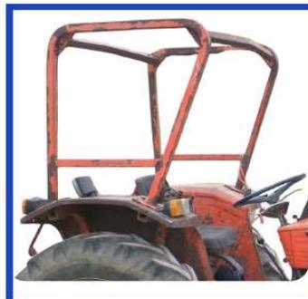
Ad esempio, il controllo da effettuare sul dispositivo di protezione in caso di capovolgimento è quello atto a rivelare eventuali difetti dei singoli componenti (generalmente lamiere e tubolari profilati e/o laminati) e dei giunti saldati (con particolare riguardo a corrosione, cricche, ammaccature non trascurabili, tagli, ecc.).
