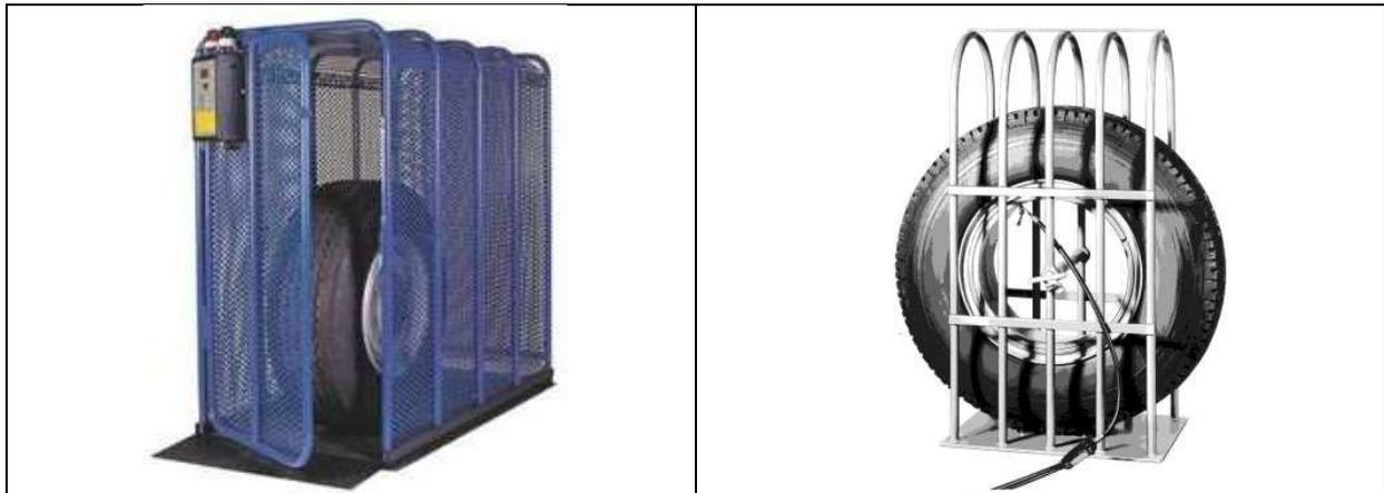
Fig.1: Esempi di gabbie fisse e portatili per il gonfiaggio degli pneumatici
