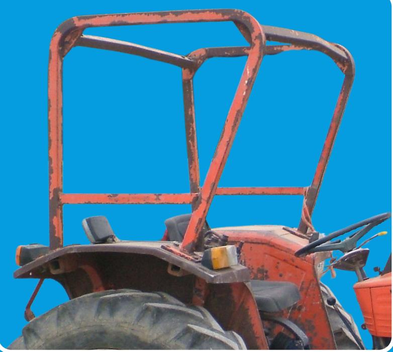
Ad esempio, il controllo da effettuare sul dispositivo di protezione in caso di capovolgimento è quello atto a rivelare eventuali difetti dei singoli componenti (generalmente lamiere e tubolari profilati e/o laminati) e dei giunti saldati (con particolare riguardo a corrosione, cricche, ammaccature non trascurabili, tagli, ecc.).
