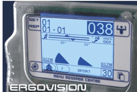
Carico; set; ripetizioni; angolo di rotazione; watt; pausa; velocità; Feedback velocità e R.O.M
